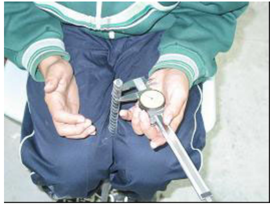
圖七 以遊標尺測量鋼筋直徑
