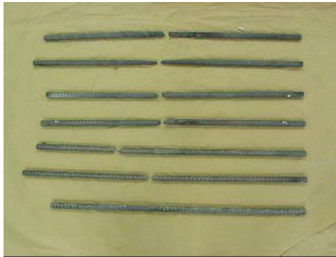
圖八 鋼筋在不同溫度下被拉斷 (由上至下分別為室溫、 200^{\circ}\text{C} 、 400^{\circ}\text{C} 、 600^{\circ}\text{C} 、 800^{\circ}\text{C} 、 900^{\circ}\text{C} ，最下方為試驗前之原來鋼筋)
