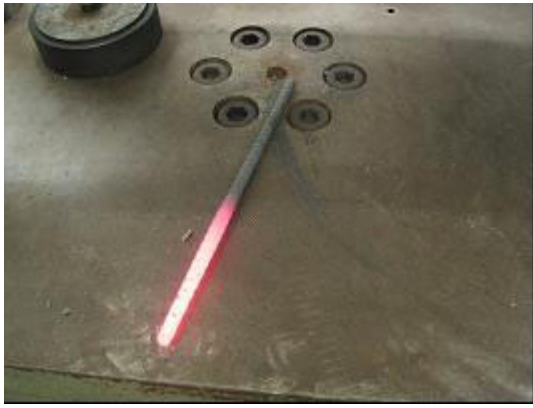
圖六鋼筋在高溫下被拉斷
