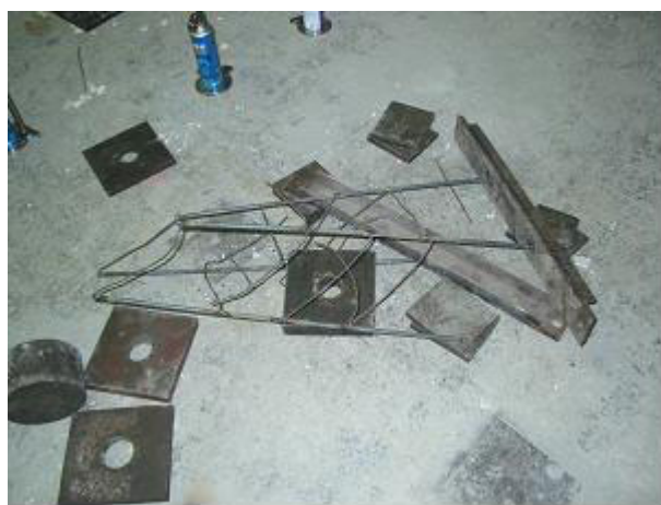
圖十三 鋼架在高溫燒烤下倒塌
